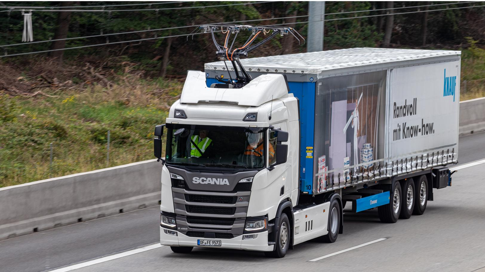
Scania Oberleitungs-Lkw des Baustofflieferanten Knauf.
