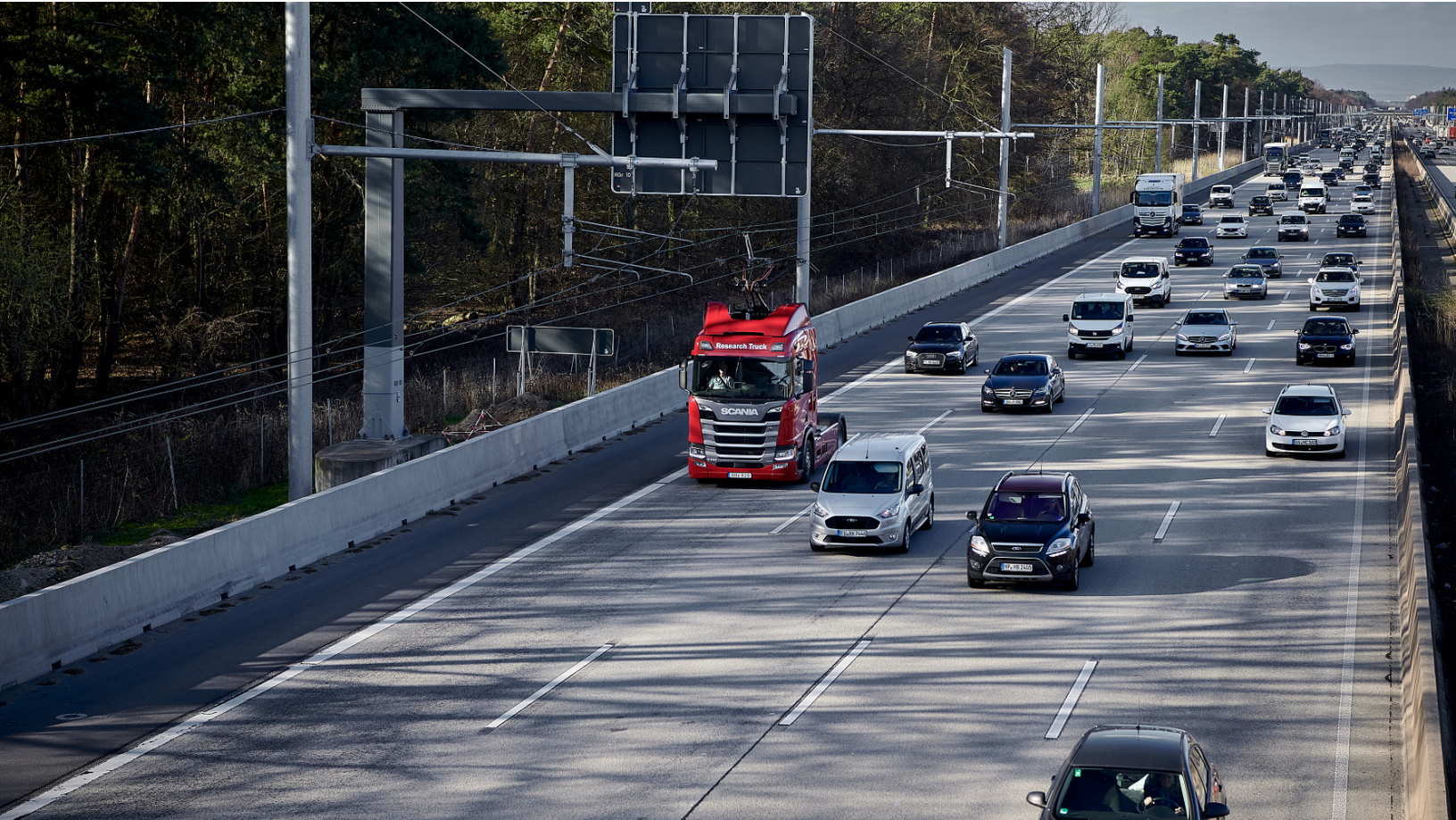
Scania Oberleitungs-Lkw mit Hybridantrieb auf der E-Highway-Teststrecke der A5 bei Frankfurt.
