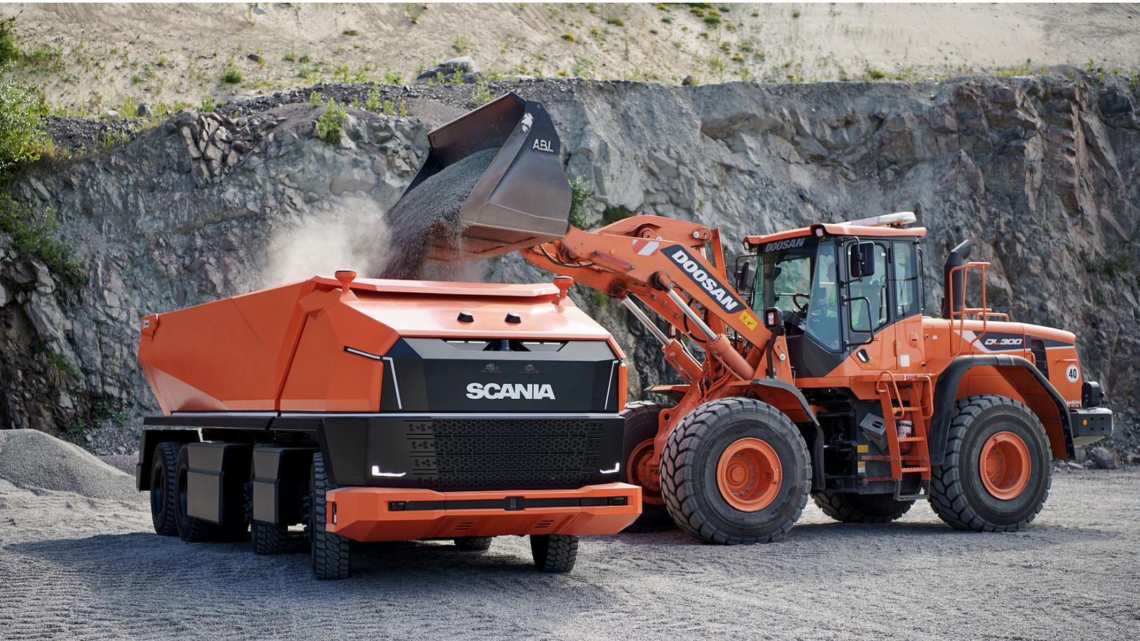
Mit dem Scania AXL präsentiert Scania einen neuen Konzept-Lkw: vollständig autonom und ohne Fahrerhaus.
