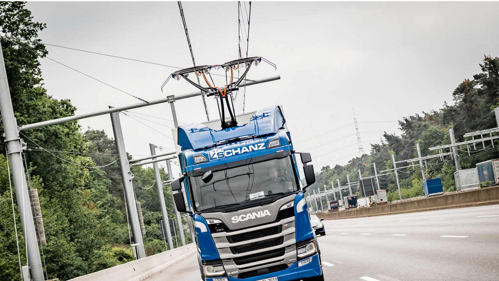
Scania R 450 Oberleitungs-Lkw auf der A5-Teststrecke bei Frankfurt.
