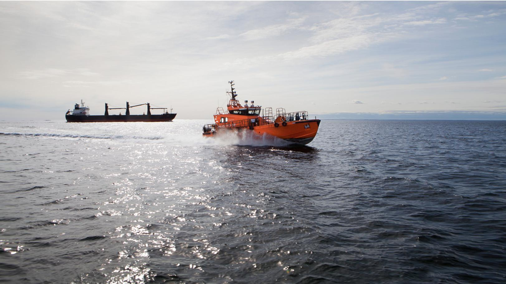
Ein Lotsenboot der schwedischen Schifffahrtsverwaltung, angetrieben von zwei Scania 16-Liter-Marinemotoren, V8.
