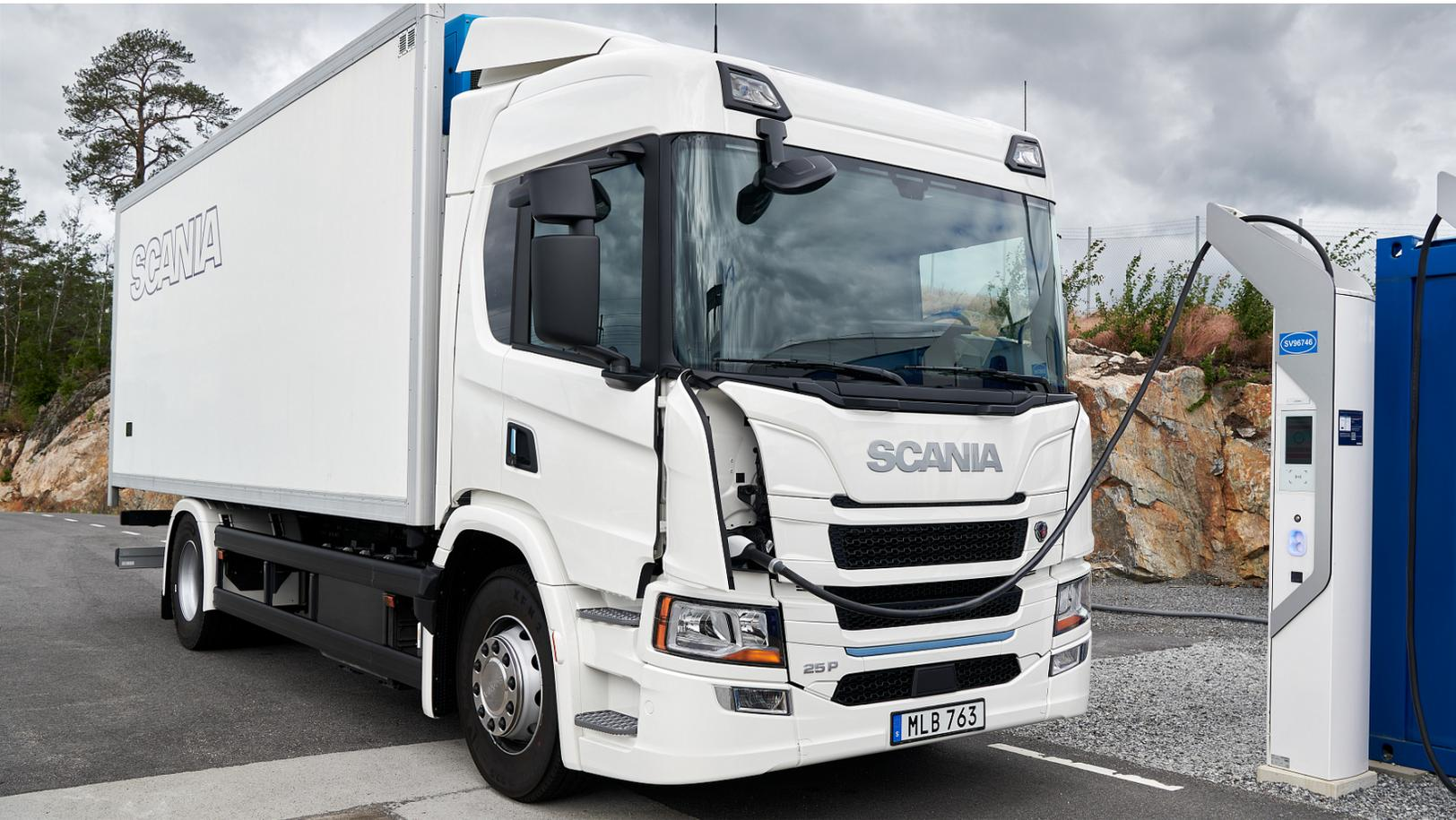
Der erste vollelektrische Scania ist wahlweise mit 5 oder 9 Batterien erhältlich.
